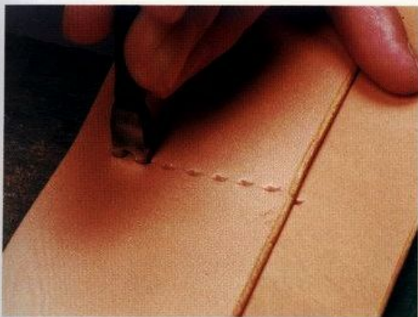
30 カード入れ1と2の段差を1目分跨ぐようにして、ヒシ目打ちを打っていく
