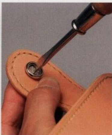
42 本体のベルト部分にコンチョを差し込み、裏側からジャンパードット(凹)を挟んでマイナスドライバーで固定する
