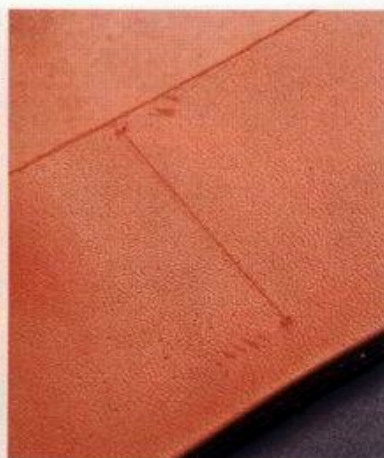
29 カード入りを貼り合わせたら、カード1に中央線を引く。下から1cm程度あけておくこと
