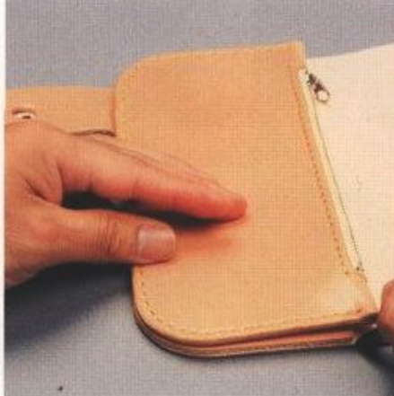
35 ポケットとカード入れを本体の取り付け部分に合わせ、のりしろの位置に印を付ける
