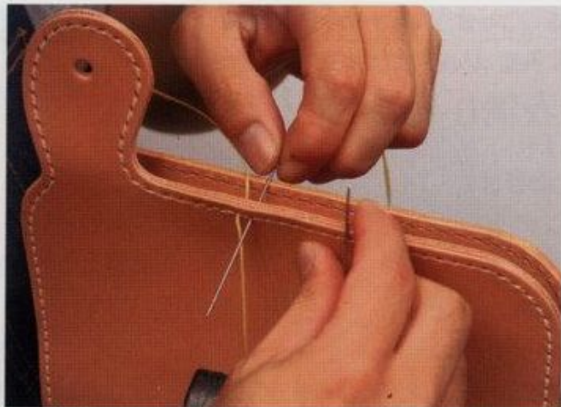
39 本体とポケット、カード入れを縫っていく。革を2枚、3枚重ねている部分は強めに縫うこと
