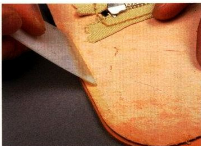
18 ヘラを使ってポケット1にボンドを塗る。パリーイーではエルスーパーボンドを使用
