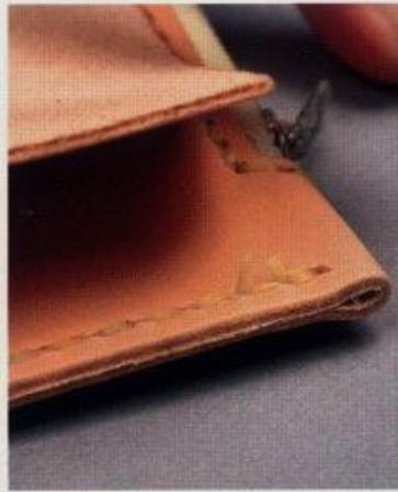
24 縫い終わりは2重に返してから1目分戻り、内側へ糸を出す。2mm程残して糸をカットしたら、ライターであぶって固着させる
