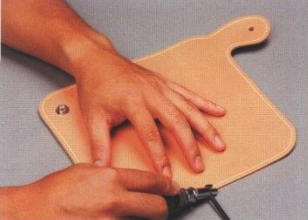
34 ステッチンググルーバーで本体に3mm幅の縫い線を付ける。曲線はゆっくり慎重に動かす
