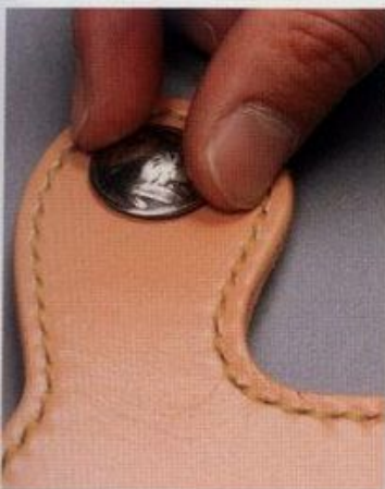
42 本体のベルト部分にコンチョを差し込み、裏側からジャンパードット(凹)を挟んでマイナスドライバーで固定する
